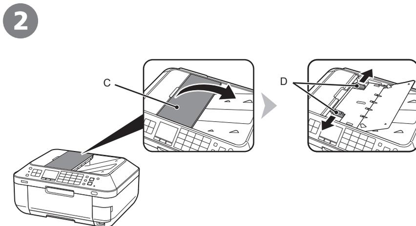
打开文档托盘(C)，然后移动文档导片(D)到两端边缘。
