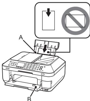
将纸张打印面向上纵向装入后端托盘(A)。
