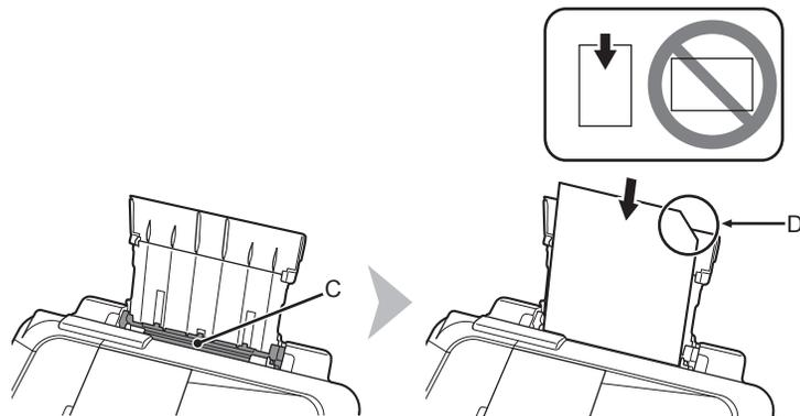
在后端托盘(C)中装入一张附带的专业纸张(无光泽照片纸MP-101)。
