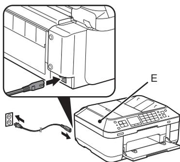
将电源线稳固地插入本机背面左侧的电源线连接器，并稳固地连接到壁装电源插座上。
