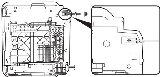
如果发送或接收需要很长时间，或出现较多故障，将一根地线连接至本机底部的螺丝钉上可能会使情况得到改善。安装地线时，请如图所示，确保沿本机上的凹槽放置地线，并且小心不要让本机压在地线上。
