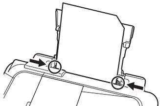
滑动左右纸张导片，使其紧靠纸张两侧边缘。
