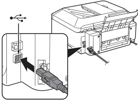
打印机连接屏幕出现时，使用USB电缆线将本机连接到计算机。
