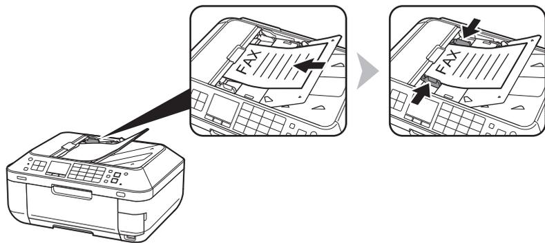
插入文档直到响起哔声，然后滑动左右文档导片使其紧靠纸张两端。
