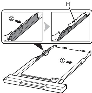
将纸张与纸盒的右侧(1)对齐，并滑动左纸张导片使其紧靠纸张左侧边缘(2)。
