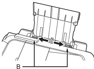
移动纸张导片(B)到两侧边缘。
