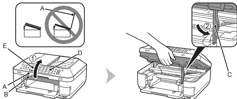
1. 确保文档盖板(A)已关闭, 然后将其抬起以打开扫描单元(机盖)(B)。
