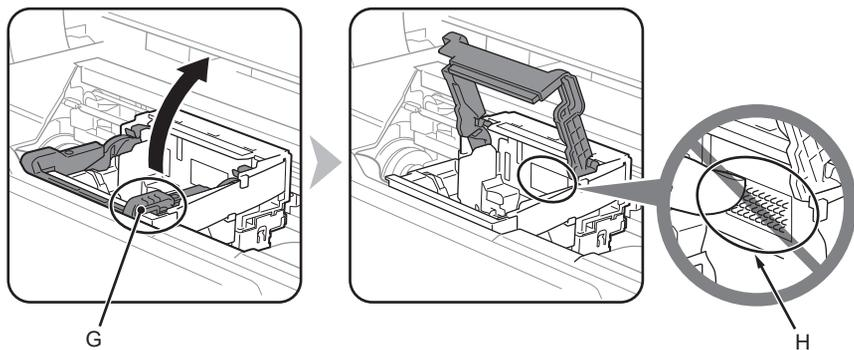
稳固地抬起打印头固定器的打印头锁定杆的(G)部分直到其停止。
