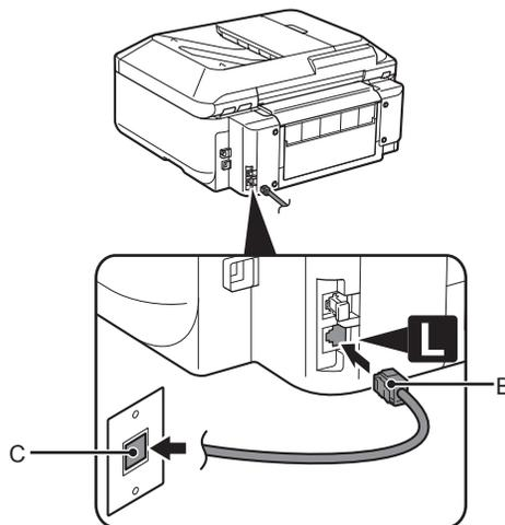
将随附的电话线(B)的一端连接到本机下方标有“L”的连接器上，然后将另一端连接到墙壁上的电话线插口(C)中。
