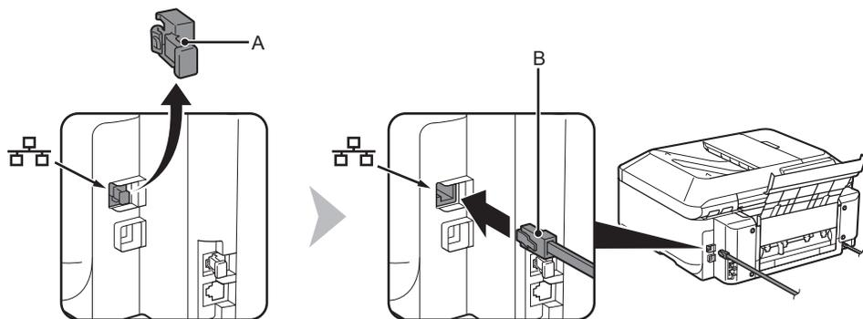
取下盖(A)，然后使用以太网电缆线(B)连接网络设备(路由器等)。
